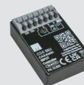
Модуль сухих контактов для беспроводного управления C14 AC **NEW**
